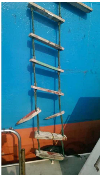
图 3 船方使用自制并且不合格的引航梯
