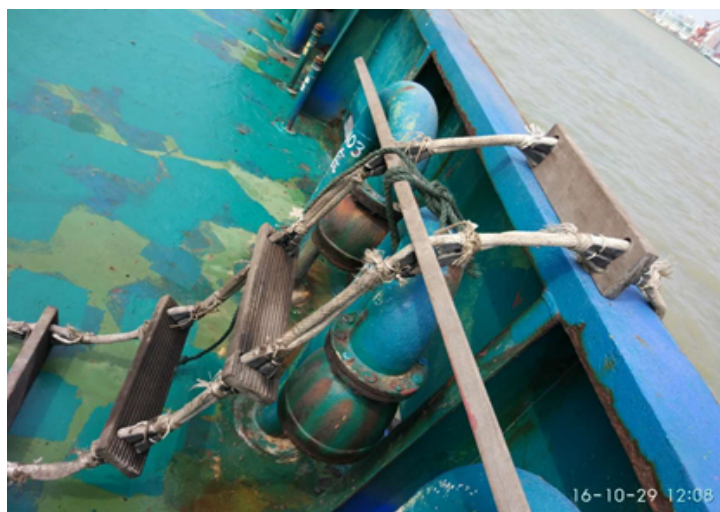
图 4 船方没有使用舷墙梯和安装了破烂的引航梯
