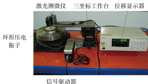
图7 性能测试装置图
