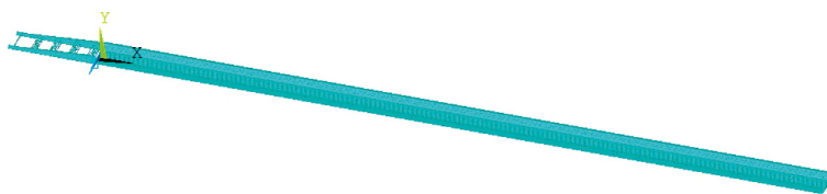
图 2 钢梁顶推施工计算模型
