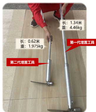
图5 第一代理置工具和第二代理置工具对比图
