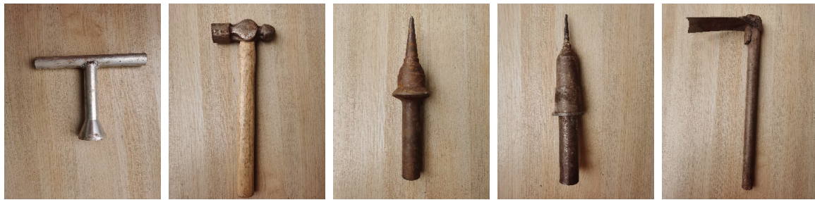
图 1 现有软土层检波器埋置工具示意图
