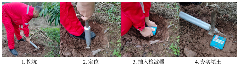
图7 一体化埋置工具埋置检波器流程图示
