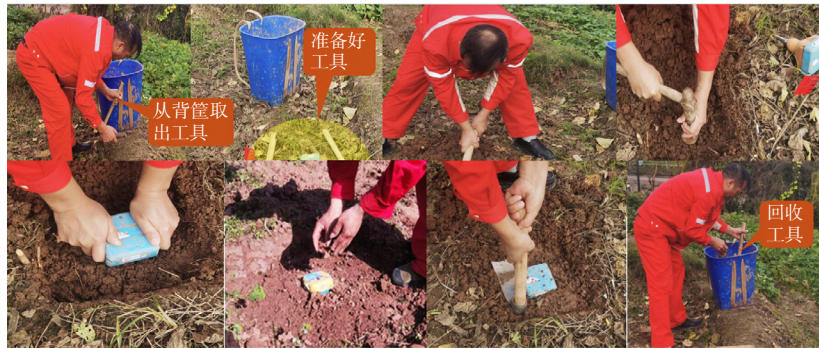
图6 传统工具埋置检波器流程图示
