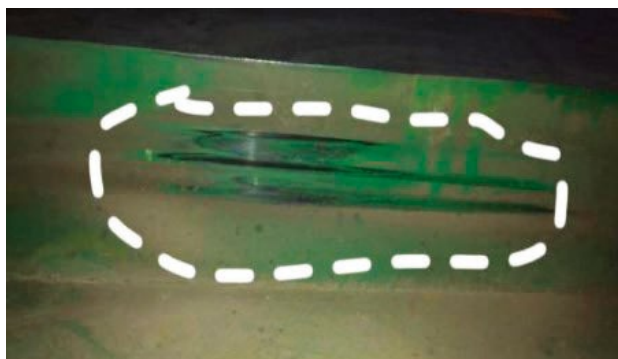
图 3 皮带与保护罩的磨痕
